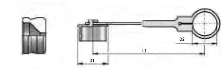
EN ACIER POUR VA8R (COTE REMORQUE) - EN PE POUR VA8T (COTE TRACTEUR)
